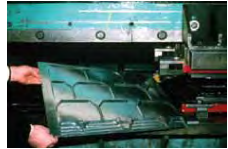
Une tuile en tôle embossée d'époque a été utilisée comme prototype pour la fabrication de tuiles de remplacement dans la restauration du bâtiment principal du Motherwell Homestead, près d'Abernathy, en Saskatchewan. Dans les projets de restauration, la réparation ou le remplacement des éléments manquants ou très détériorés se fait à l'identique, sur la base de preuves physiques, documentaires ou orales.
