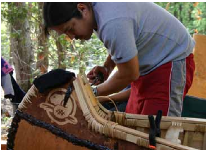
Fabrication d'un canot en écorce de bouleau Photo : Parcs Canada
