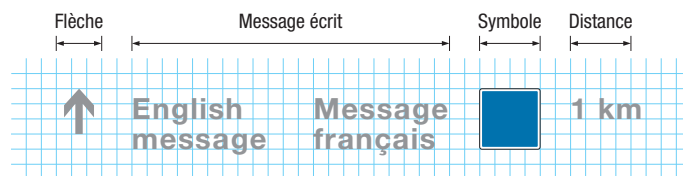
Figure 3.12 – Éléments du panneau
