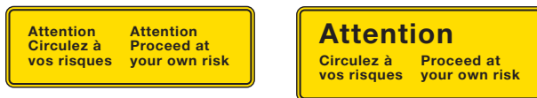
Figure 3.23 – Hiérarchiser le message améliore l'efficacité d'un panneau. Le titre plus gros (à droite) retient l'attention du lecteur et introduit le message fondamental, plus petit.
