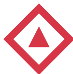
Figure 2.13 – Balise de bifurcation/jonction de tribord
