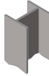
Poteau en acier de qualité structurale à section en I, selon les spécifications d'un ingénieur (dimensions variables)
