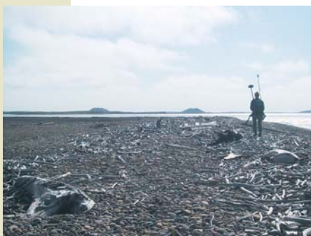
Levé d'une ligne de rivage à Tuktoyaktuk à l'aide d'un système mondial de localisation (GPS).
